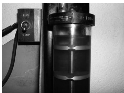
Εικόνα 5: Μέτρηση κατανάλωσης 50 cm 3 καυσίμου από την ακμή του πρώτου δίσκου έως την ακμή του δεύτερου.
